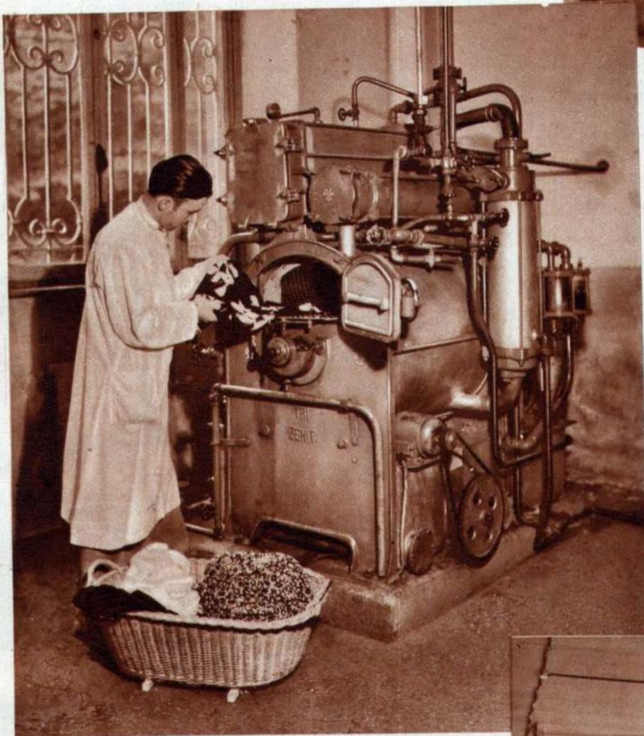
Sopra: la macchina per la lavatura a secco. —
