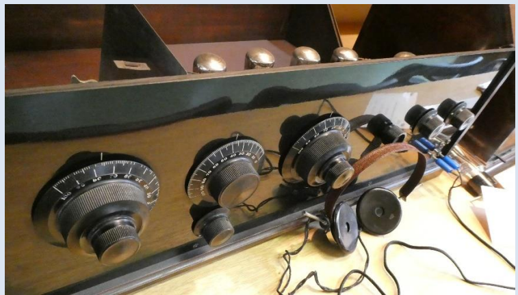
1925 Ricevitore a tre stadi di sintonizzazione, di demodulazione a valvole e la classica cuffia (MdR)
