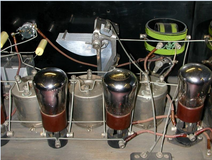
1928. Valvole e elementi costruttivi di un ricevitore radio del 1928
