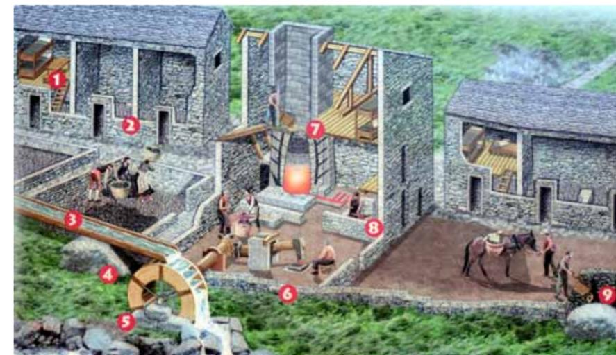
Ricostruzione ipotetica del maglio e del forno: **1** Alloggi delle maestranze. **2** Magazzini. **3** Depositi carbone, minerale e calcare. **4** Canale di adduzione. **5** Ruota del maglio. **6** Maglio ad acqua. **7** Altoforno. **8** Forge. **9** Deposito delle scorie d'altoforno.
